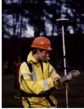
الشكل (١٢): يتألف جهاز GPS من الهوائي وجهاز الاستقبال (على الكتف) وجهاز النقاط البيانات (في اليد).
